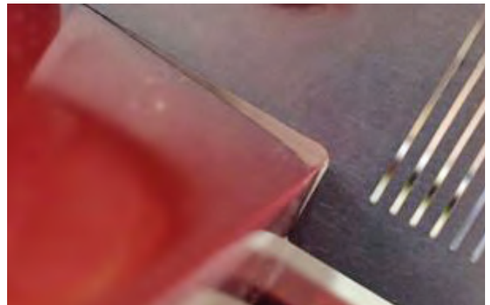
Bild der zu scharfen Kante (mit SMGV-Gitterschnitt- und Kantenlehre)
